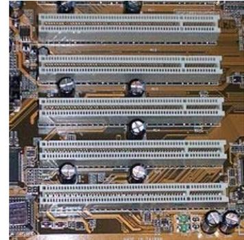
**Le slot PCI** : généralement blanc il disparaît des cartes mères depuis 2008 et est en train d'être remplacé par le port PCI Express. Il suffit d'y insérer une carte.
