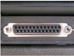
Le port série ou port COM est un port de communication avec divers périphériques externes, ce port est encore utilisé aujourd'hui mais est progressivement remplacé par l'USB.
